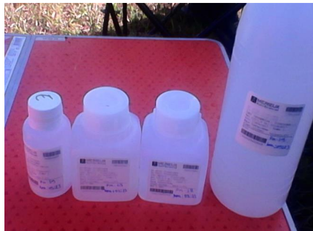
Fotografia 2 e 3: A fotografia 2 a esquerda exibe a amostra sendo filtrada para a coleta de isótopos. A fotografia 3 à direita mostra os fracos para a coleta de metais totais, metais dissolvidos, ânions, cátion e alcalinidade.
