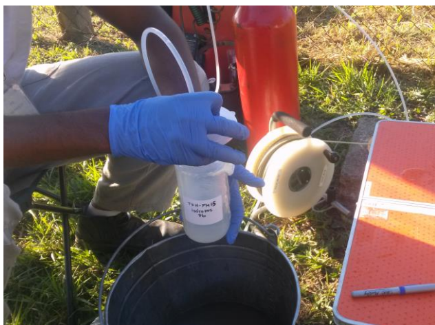
Fotografia 2 e 3: A fotografia 2 a esquerda exibe a amostra sendo filtrada para a coleta de isótopos. A fotografia 3 à direita mostra os fracos para a coleta de metais totais, metais dissolvidos, ânions, cátion e alcalinidade.
