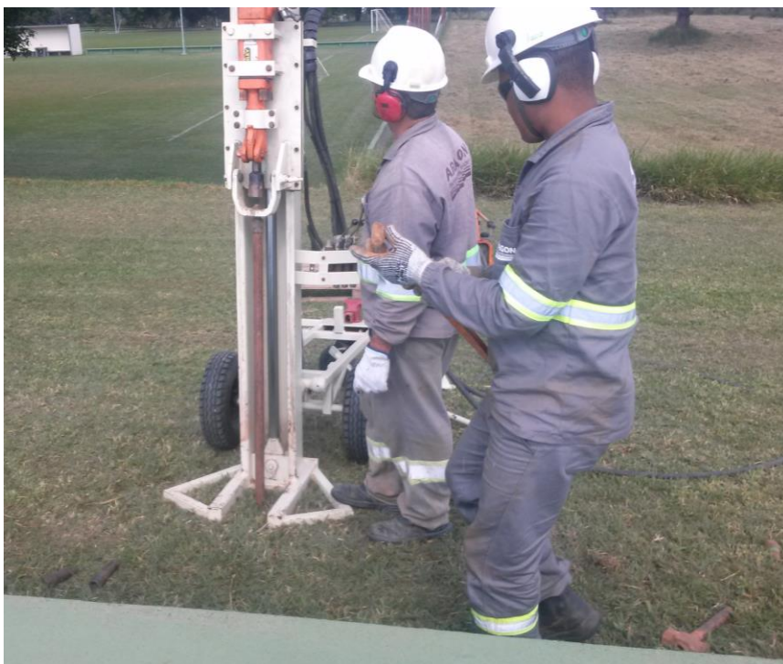
Fotografia 4: Geoprobe com o liner no amostrador.
