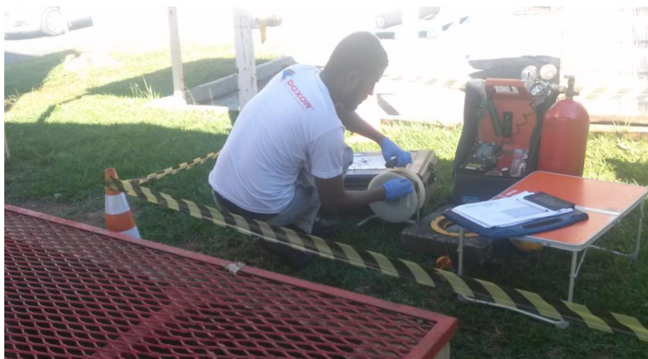
Fotografia 1: Amostragem do PM-02, e ao lado da mesa a controladora de baixa vazão.
